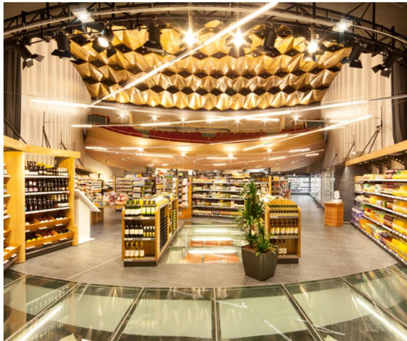
**Abb.:** Die Regalbeleuchtung wurde mit eingesetzten Lichtlinien realisiert, die durch eine asymmetrische Abdeckung genau auf das Produkt ausgerichtet ist und den Betrachter nicht blendet.
